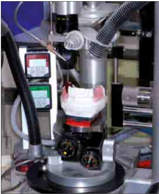
Fig. 21 Controllo del parallelismo delle pareti dei pilastri
